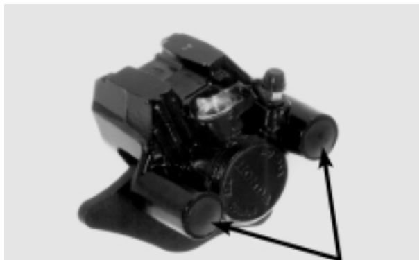
BUJÕES DOS PINOS DESLIZANTES CORPO DO CÁLIPER
